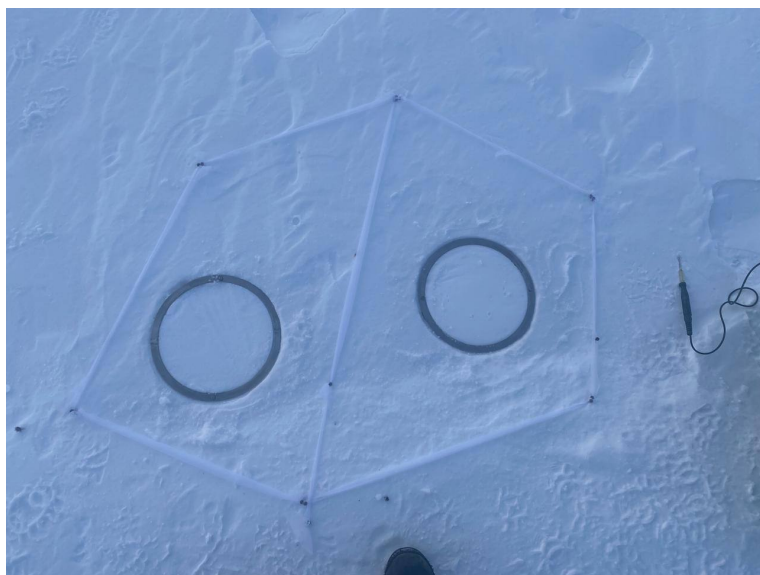
Рис. 1. Снегоиспарительная площадка с испарителями ГГИ-500-6, защищенная капроновой сеткой, и электронный термометр для измерения температуры поверхности снега
