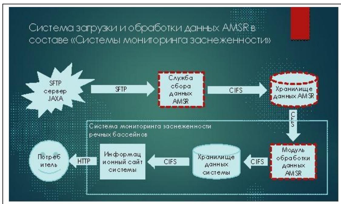
Рисунок 1- система загрузки и обработки данных AMSR в составе «Системы мониторинга заснеженности»
