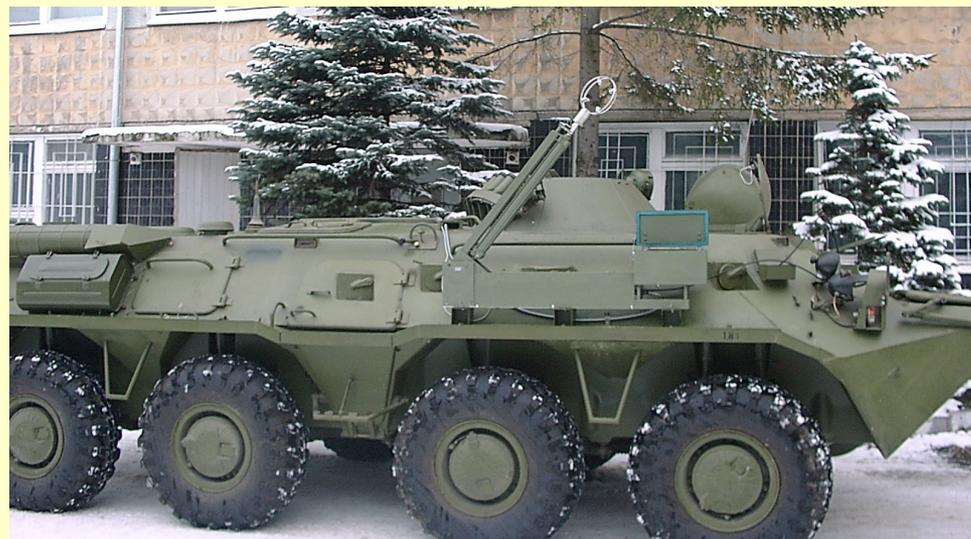
**БМК-02 на машине радиационной и химической разведки. (Стадия развертывания метеомачты). Контейнеры, в которых размещается ДСВ-15, обеспечивают проведение процесса самокалибровки датчиков скорости ветра и температуры.**
