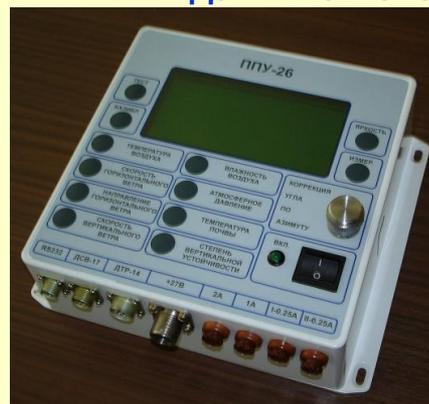
**Пульт управления работой БМК и индикации усредненных значений измеряемых метеовеличин (вариант исполнения)**
