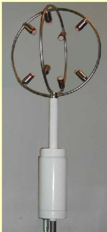
**Ультразвуковой термоанемометр ДСВ-16**
