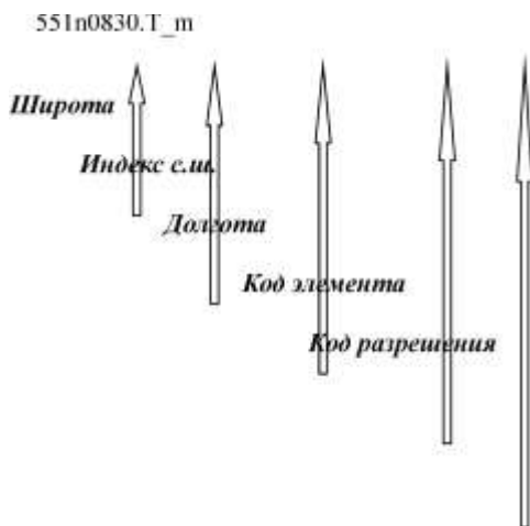
Рис. 2. Кодировка имени файла базы, содержащего данные о среднемесечной температуре приземного воздуха по ГМС «Новосибирск» (55,1° с. ш., 83,0° в. д.)
