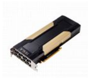
Плата для ускорения вычислений NVIDIA Tesla V100 PCIe 5120 cores 4096-bit 32 GB CoWoS HBM2 with ECC Цена: 600 - 800 тыс руб., облако около 18 USD\час
