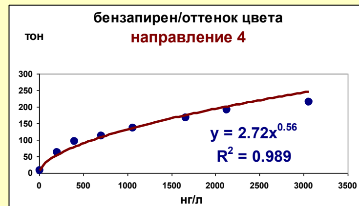
Рис. 8. Функциональная связь между интенсивностью изменения тонов серого цвета и полями выпадения БП от НЭЗ в направлениях II – IV
