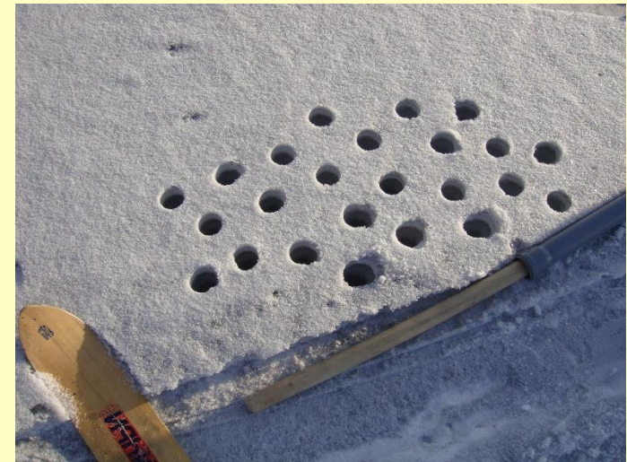
Рис. 1. Схема отбора снеговых проб в районе НЭЗ .
