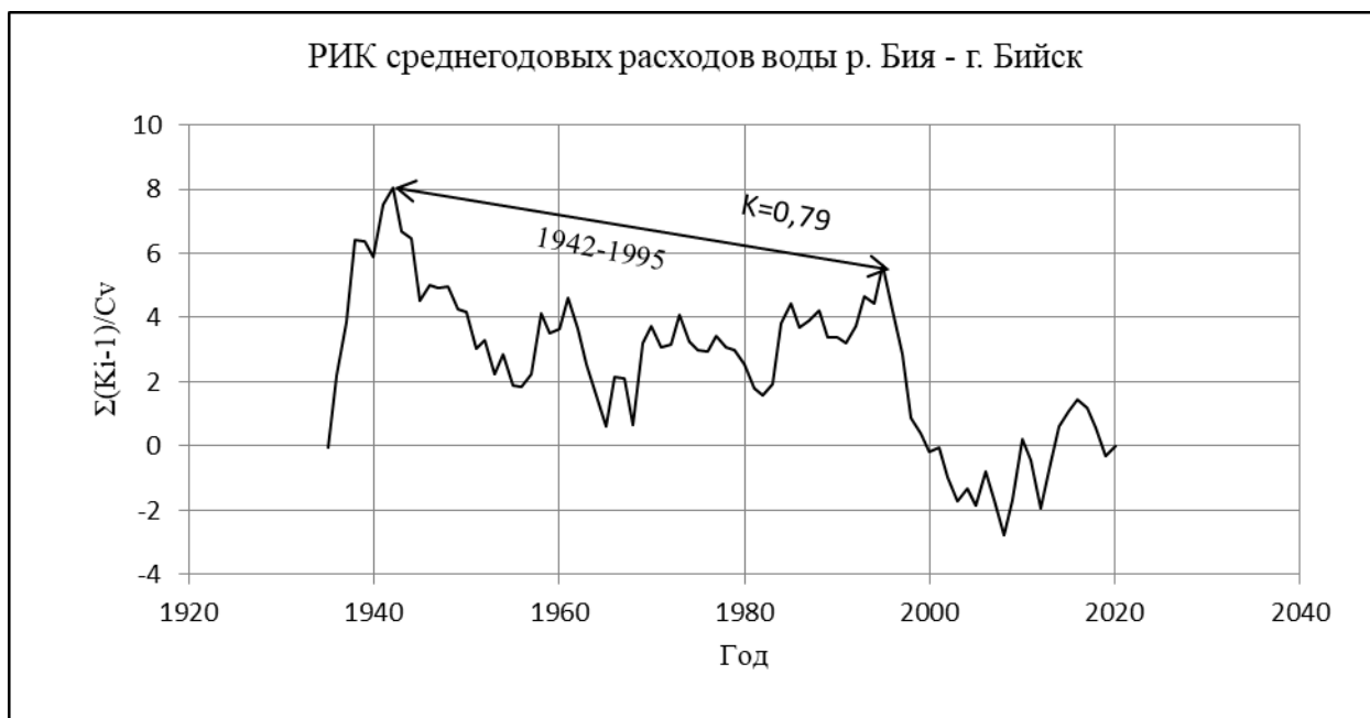
Рисунок 23 - Пример построения разностной интегральной кривой среднегодовых расходов воды
