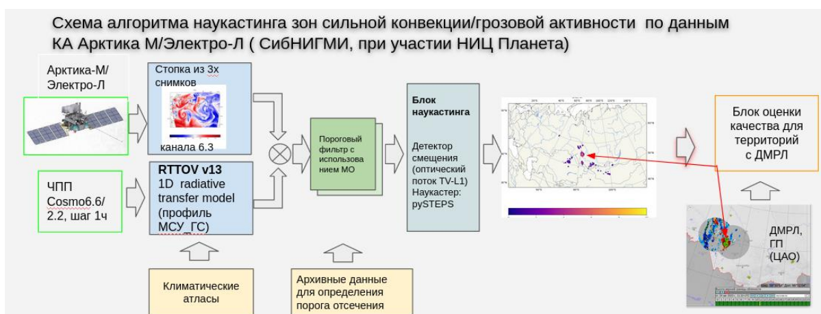
Рисунок 26 - Улучшенный алгоритм наукастинга зон сильной конвекции/грозовой активности для территории Урала и Сибири
