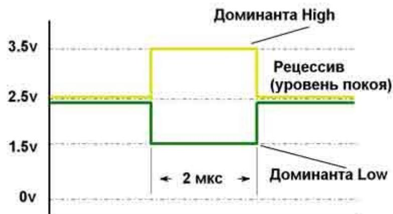
Две линии- инвертированы. Возможен аварийный режим однопроводной схемы.
